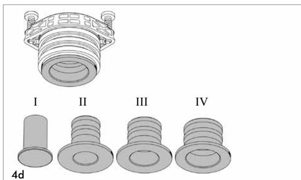
Blindstopfen und eine Moduldichtung (I-IV) entfernt:
