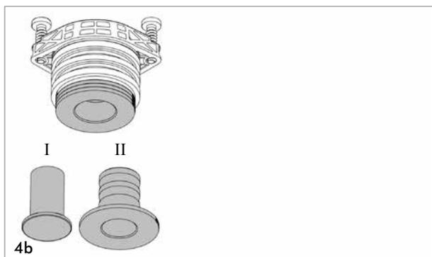
Blindstopfen und eine Moduldichtung (I-II) entfernt:
