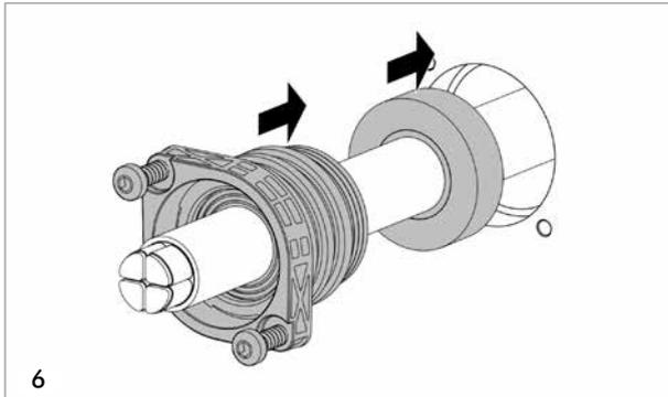
Ringstopfen (Sekundärdichtung) aus dem Zubehörset entnehmen. Abdichteinheit montieren: zuerst den angepassten Ringstopfen (Sekundärdichtung) danach die Abdichteinheit.
