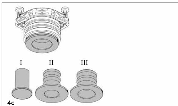
Blindstopfen und zwei Moduldichtungen (I-III) entfernt:
