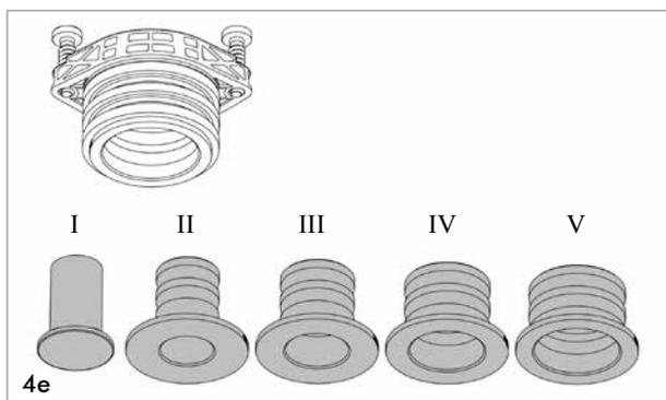
Blindstopfen und eine Moduldichtung (I-V) entfernt:
