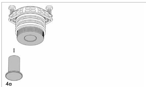
Blindstopfen (I) entfernt: Leitungsdurchmesser von 25 - 29 mm.
